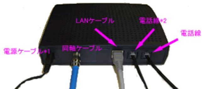
※1. 電源を切るときは電源ケーブルを抜くか、電源アダプターを外してください。
